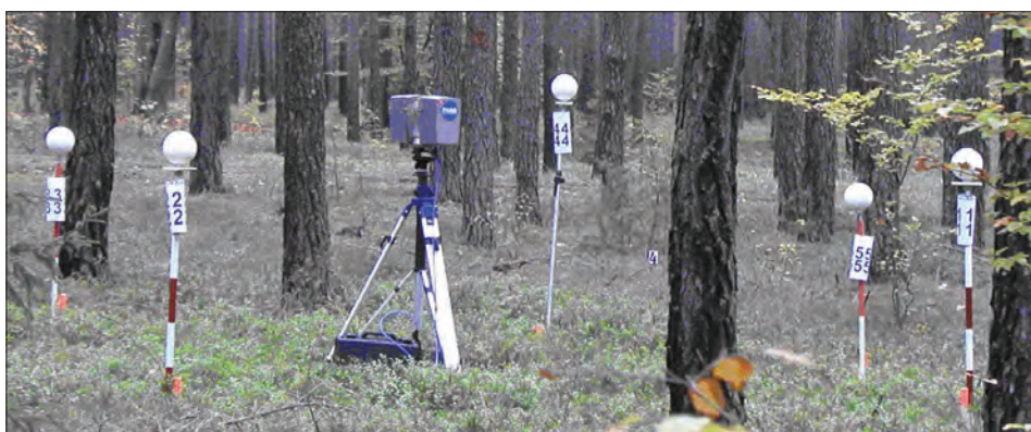
Ryc. 14.5.2.4. Skanowanie kołowej powierzchni próbnej. Skaner FARO LS 880 na stanowisku S_1 centralnym; widoczne ponumerowane kule referencyjne (fot. P. Wężyk)
