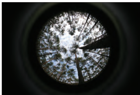
b) zdjęcie hemisferyczne w drzewostanie sosnowym, wykonane zestawem Canon EOS 20D + Canon EF-S 18-55/3,5-5,6 + konwerter Raynox dcr-cf 185pro (rzeczywisty kąt widzenia: 185°)
