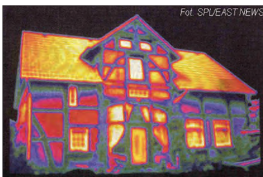
Ryc. 14.1.16. Przykłady zobrazowań termalnych. Zdjęcie obok pokazuje wady izolacji budynku. Zdjęcie dolne, zarejestrowane przez skaner Thematic Mapper satelity Landsat (kanał 6: 10,4–12,5 \mu\text{m} ), pokazuje rozkład temperatury w okolicach Puszczy Kozienickiej (niska temperatura wód i lasów – ciemne tony, oraz wysoka terenów zabudowanych, odkrytej gleby, piasków – tony jasne)
