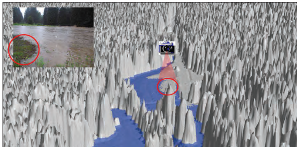
Ryc. 12.4.2. Porównanie symulowanego na NMT stanu wody z jej poziomem zarejestrowanym na zdjęciu, wykonanym 6 sierpnia 2006 r.
