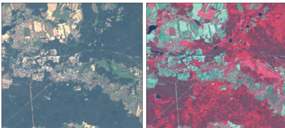
Rycina 14.3.3. Przykład kompozycji barwnych zdjęcia wykonanego skanerem Enhanced Thematic Mapper przez satelitę Landsat 7.
