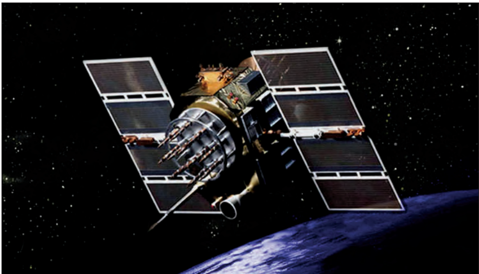
Ryc. 15.3. Satelita systemu nawigacyjnego GPS Navstar (źródło: http://pnt.gov )
