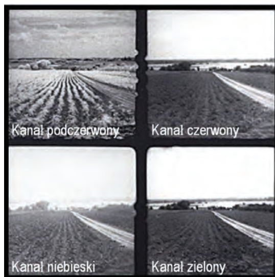
Ryc. 14.1.17. Przykład terenowego zdjęcia wielospektralnego, na którym zarejestrowano zakresy: niebieski, zielony, czerwony i bliskiej podczerwieni (fot. M. Ostrowski)
