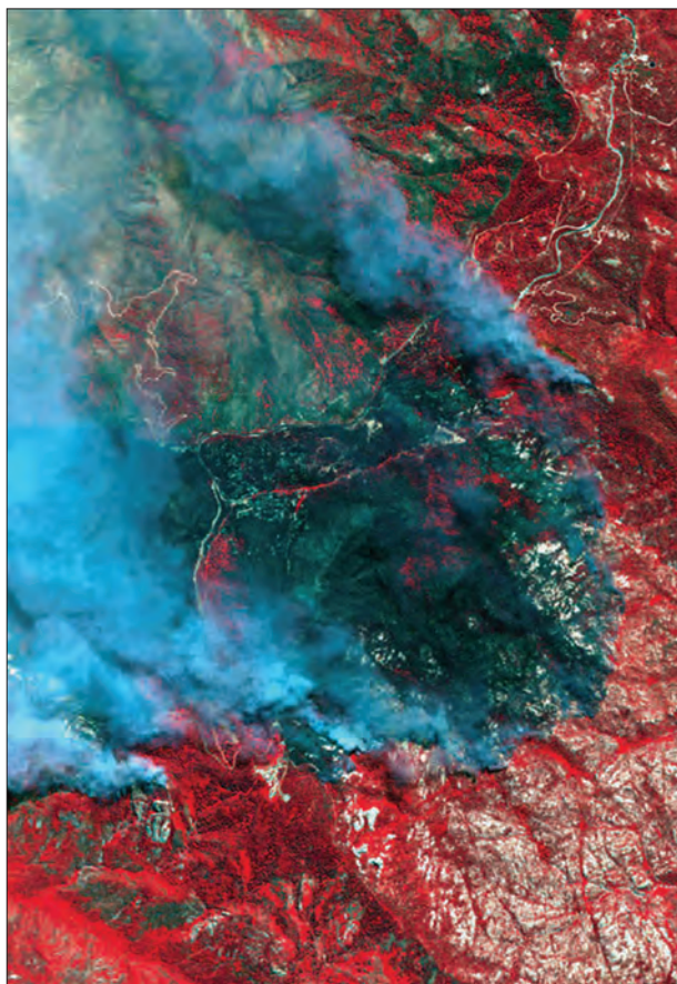
Ryc. 14.10.12. Pożar lasu. Kompozycja w barwach umownych, wykonana z obrazu wielospektralnego satelity IKONOS, pokazująca pożar lasu w Arizonie (USA). Kolor czerwony – roślinność żywa, nie objęta pożarem (źródło: www.techmex.com.pl/uds.asp?current_id=1090&i=37 )
