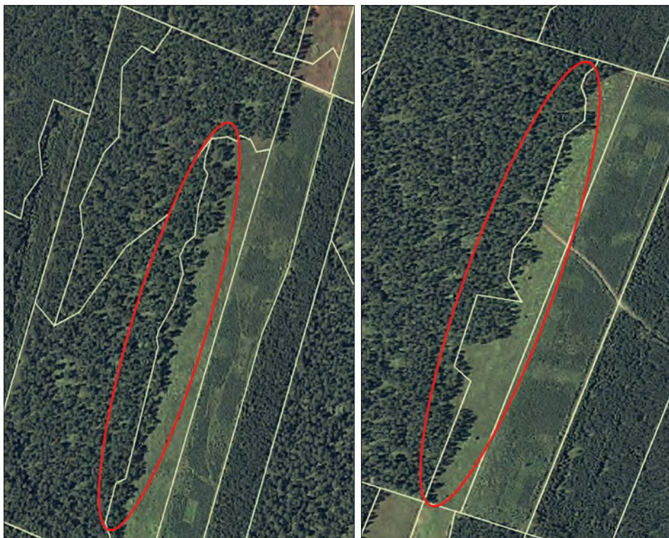
Ryc. 14.10.5. Błędy w granicach wydzieleni taksacyjnych. Obramowane na czerwono granice wyłączeń taksacyjnych wymagają niewątpliwie weryfikacji terenowej przed podpisaniem protokołu odbioru prac taksacyjnych od wykonawcy inwentaryzacji (źródło: Techmex SA; zdjęcia z satelity IKONOS)
