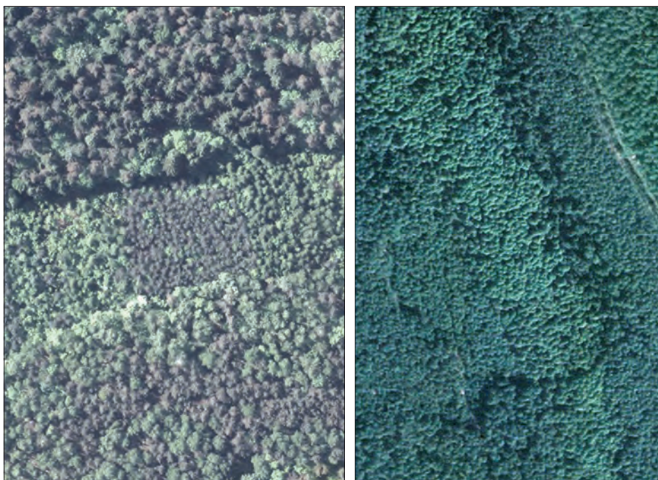
Ryc. 14.1.12. Porównanie zdjęć w barwach naturalnych wykonanych późną wiosną (zdjęcie lewe) i w środku lata (zdjęcie prawe). Na zdjęciu wiosennym wyraźnie jest widoczne zróżnicowanie gatunkowe. Na zdjęciu letnim trudno jest odróżnić nawet gatunki iglaste od liściastych
