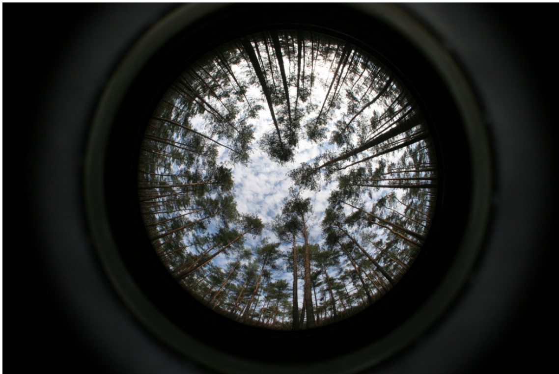
Fot. IV.3. Zdjęcie hemisferyczne nr 7440, wykonane ze środka pow. nr 17. Wykorzystano zestaw Canon EOS 20D z obiektywem Canon EF-S 18-55/3,5-5,6 oraz konwerterem typu „fish-eye” Raynox DCR-CF 185PRO; uzyskany kąt widzenia – ponad 180°.
