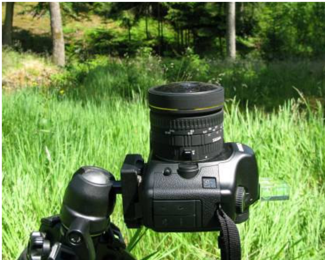
Fot. IV.7. Zestaw do wykonywania zdjęć hemisferycznych: Canon EOS 5D (matryca 12 MP) + Sigma 8 mm f/3.5 DG EX FISH EYE. (Fot. Paweł Strzeliński)
