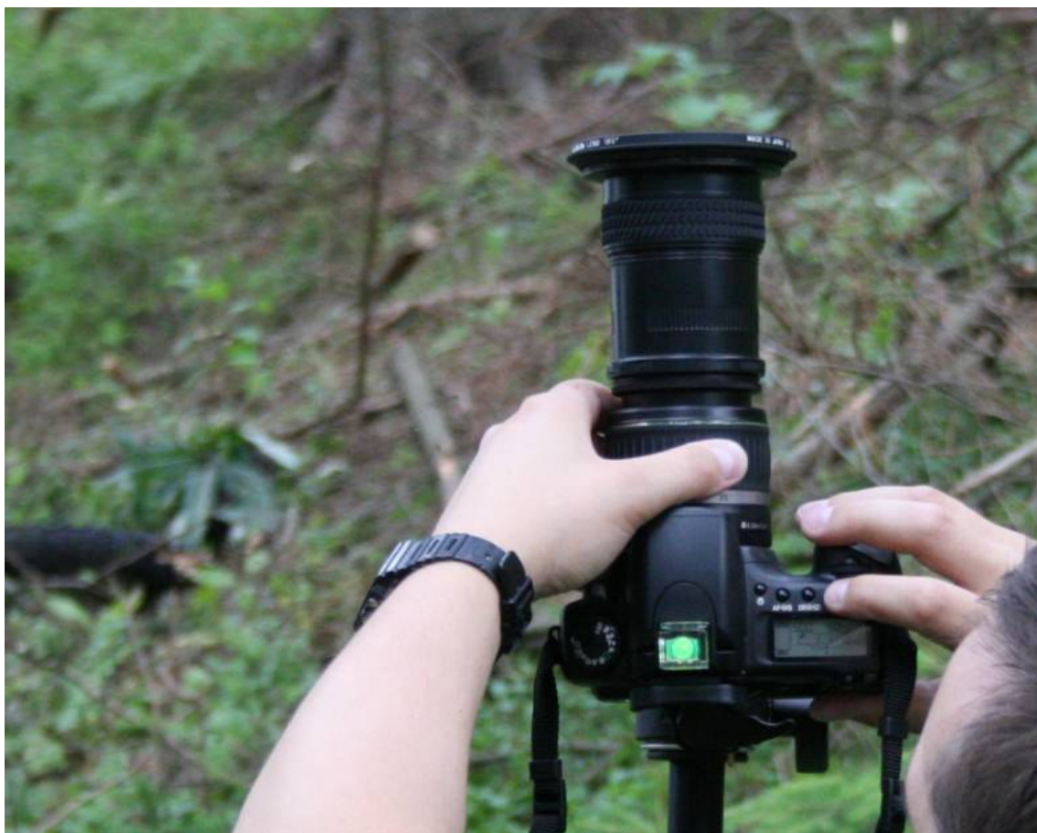
Fot. IV.1. Zestaw wykorzystywany do wykonywania zdjęć hemisferycznych: Canon EOS 20D + Canon EF-S 18-55/3,5-5,6 + konwerter Raynox DCR-CF 185PRO. (Fot. A. Damm)
