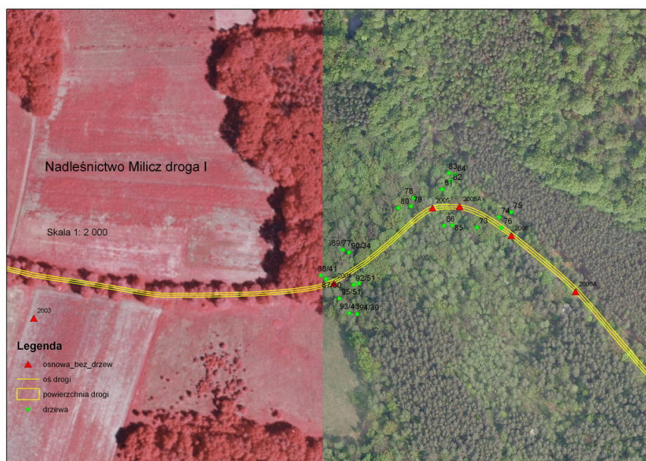
Ryc. IV.48. Oś oraz powierzchnia jednej z dróg, na których mierzono osnowy, na tle ortofotomap. Z lewej: ortofotomapa wykonana na podstawie analogowych barwnych zdjęć w podczerwieni, z pikselem 0,40m. Z prawej: ortofotomapa wykonana na podstawie cyfrowych zdjęć w barwach naturalnych, z pikselem 0,15m
