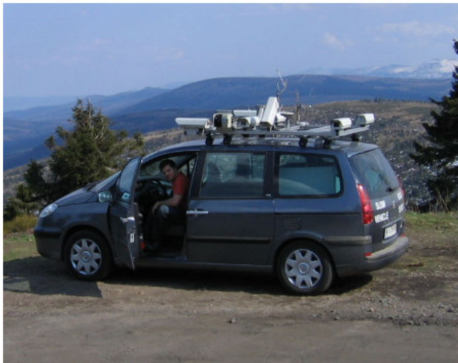
Fot. IV.8. Samochód pomiarowy wyposażony w zestaw skanerów oraz kamer fotogrametrycznych.
