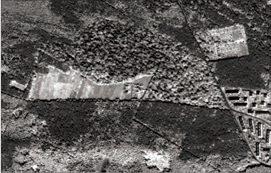
Ryc. 14.1.11. Zdjęcie panchromatyczne wykonane przez satelitę IKONOS z zarejestrowanym promieniowaniem widzialnym i bliskiej podczerwieni (0,45–0,9 \mu\text{m} ). Dzięki rejestracji promieniowania podczerwonego łatwe stało się rozróżnianie składu gatunkowego lasu (wysoka jasność spektralna gatunków liściastych powoduje, że są one zwizualizowane w jaśniejszej tonacji niż gatunki iglaste)
