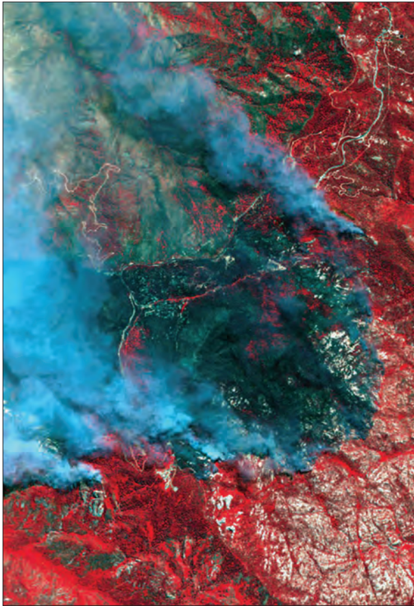
Ryc. 14.10.12. Pożar lasu. Kompozycja w barwach umownych, wykonana z obrazu wielospektralnego satelity IKONOS, pokazująca pożar lasu w Arizonie (USA). Kolor czerwony – roślinność żywa, nie objęta pożarem (źródło: www.techmex.com.pl/uds.asp?currrent_id=1090&i=37 )
