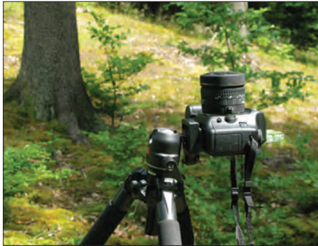
a) zestaw A: Canon EOS 5D (matryca 12 MP) + Sigma 8 mm f/3.5 DG EX FISH EYE
