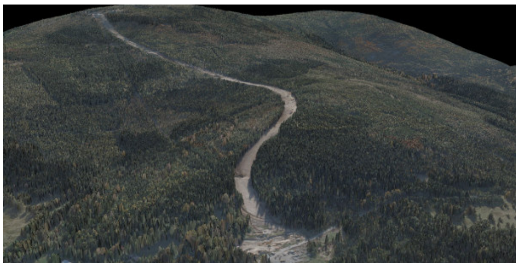
Ryc. V.6. Przykład numerycznego modelu powierzchni pokrycia terenu z nałożoną ortofotomapą (widoczna trasa nartostrady w trakcie budowy).
