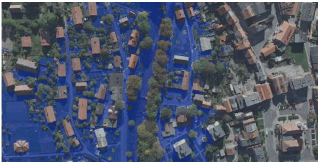
Ryc. V.8. Przykład symulacji zasięgu fali powodziowej na terenie Mirska (wysokość lustra wody 350 m n.p.m.).
